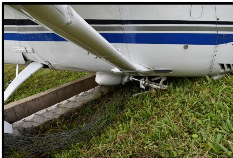
Fotografía No. 4 Vista del tren delantero derecho removido por el golpe.
