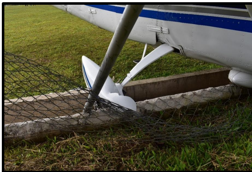
Fotografía No. 10 Vista de los daños en el tren de aterrizaje derecho.
