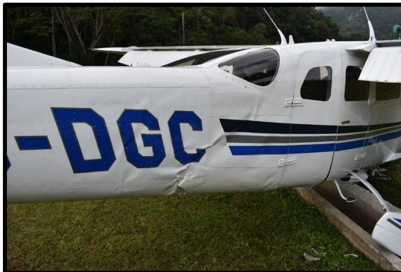
Fotografía No. 9 Vista del lado derecho de la aeronave con daños en el fuselaje.
