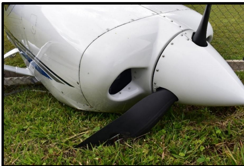
Fotografía No. 5 Vista de los daños a la hélice y tren de aterrizaje delantero.
