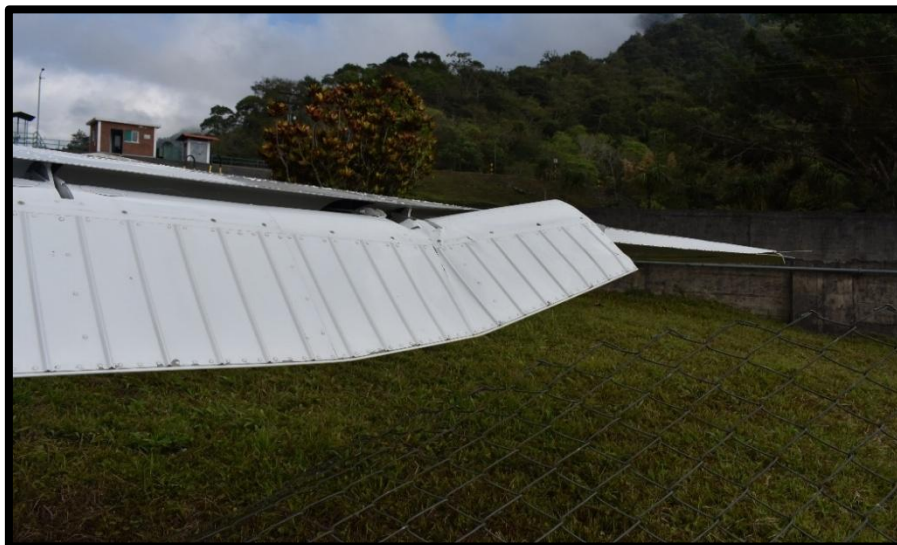
Fotografía No. 11 Vista del daño en el flap derecho.
